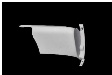
牡蠣殻混練樹脂を使用したドアパネルの試作品
